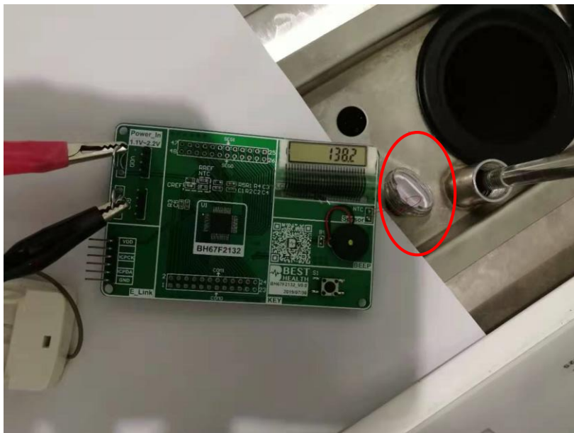
圖 6 隔离型 NTC 置于 37°C 水中，REF 路的 RC Count 数=1382
