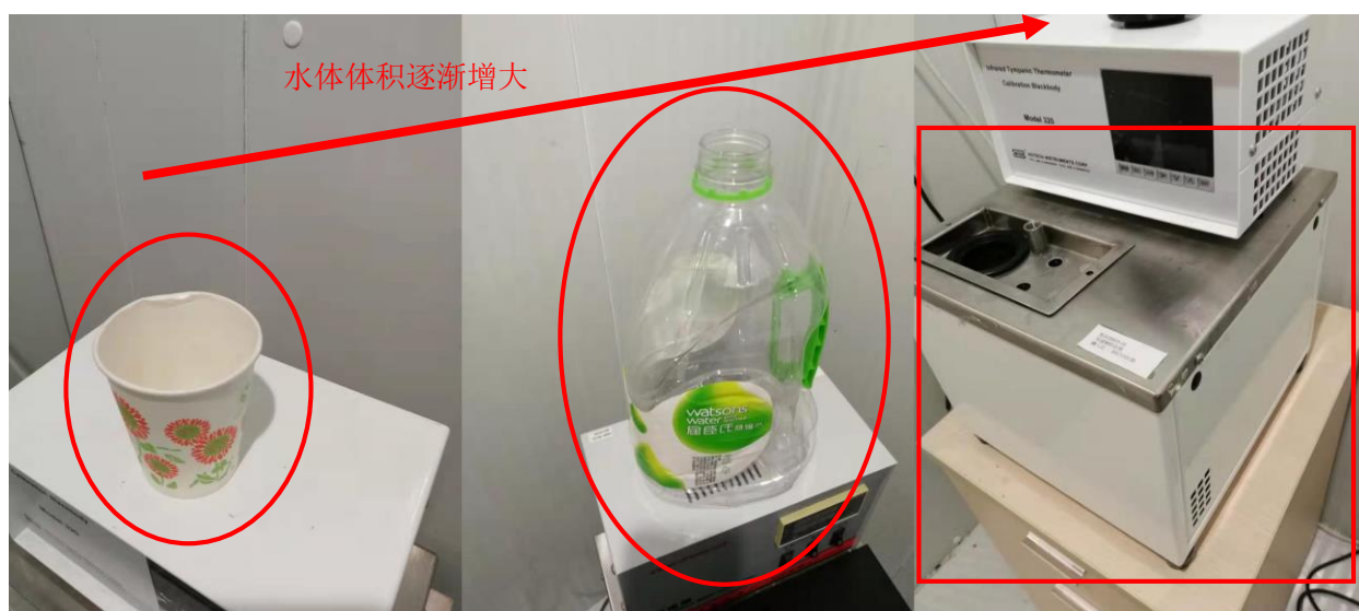
圖 8 将隔离型 NTC 置于空气中，以及后面的三个水体中 将裸露型 NTC 置于空气中，三个体积不同的水体中，发现水体体积越大，其 RC count 数与空气中的相比，越小。且对人体接触的敏感度越强。
