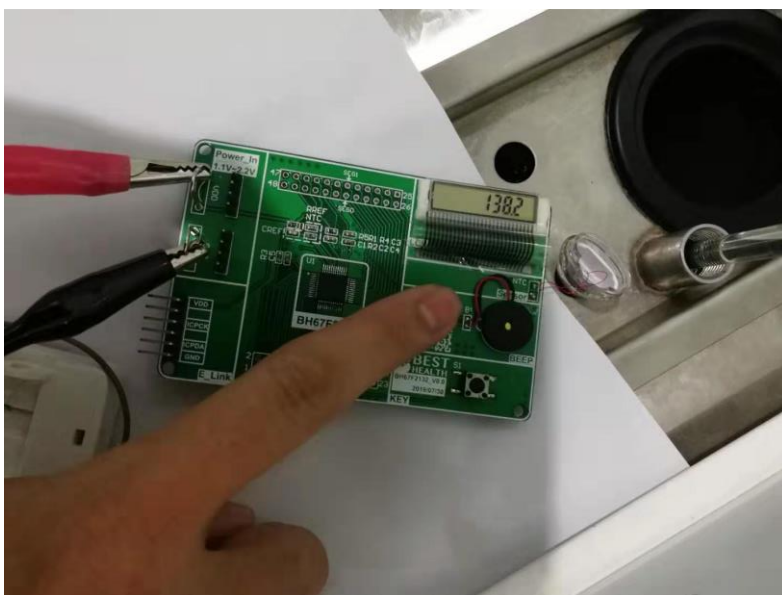
圖 7 隔离型 NTC 置于 37℃ 水中，手接触 PCB 板时，REF 路的 RC Count 数=1382
