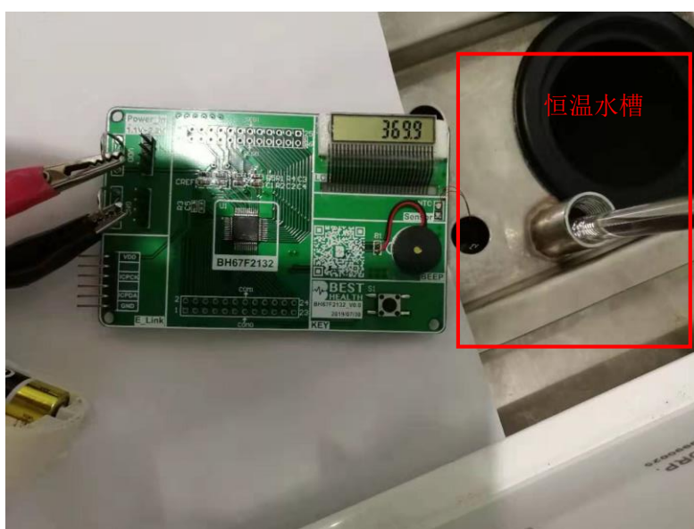
圖 2 裸露型 NTC 置于 37℃ 水中，测得温度为 36.99℃
